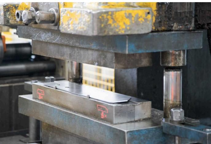
Le traitement de la tôle avec des presses de différentes capacités nous permet d'emboutir la tôle d'acier. **Segato** dispose de diverses presses internes et de collaborations externes pour tous les processus spéciaux ou dans le cas de commandes avec de grandes
