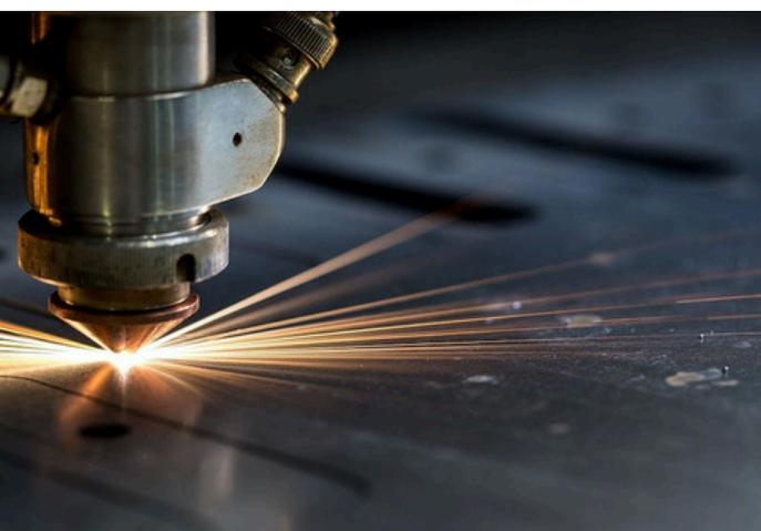
Avec cette technologie laser à fibre 2D, nous réalisons de nombreux procédés, y compris spéciaux, sur des plaques de différentes épaisseurs. Un investissement récent de l'entreprise a ajouté un laser supplémentaire pour le traitement des tubes.
