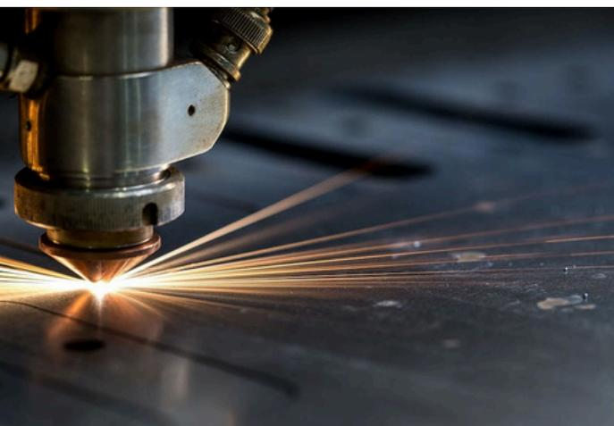
Con questa tecnologia laser fibra 2D, eseguiamo molte lavorazioni, anche speciali, su lamiere di diversi spessori. Un recente investimento aziendale ha aggiunto un ulteriore laser per la lavorazione del tubo.
