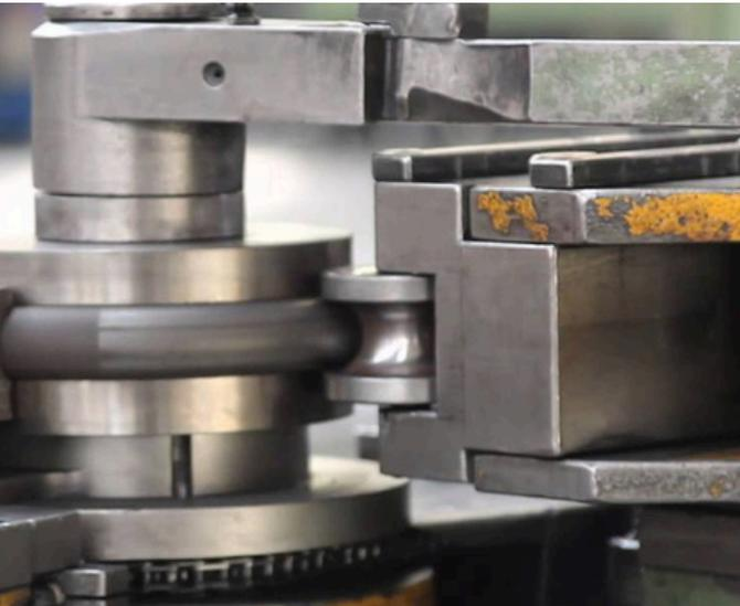
Disponiamo di una curvatubi che ci permette di eseguire lavorazioni speciali. Questa tecnologia trova un buon impiego nel settore delle strutture per ufficio per la realizzazione di design minimali o di nuovi concept.
